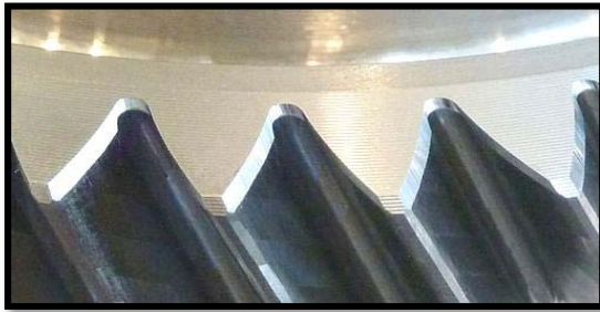
Chamfer Cut による面取り
