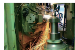
図5 高硬度歯車のcBNホブによる高速歯面仕上げ法
