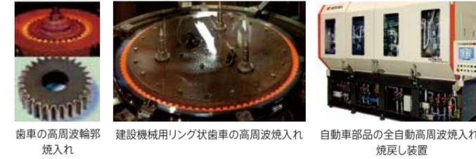
歯車の高周波焼入れ 建設機械用リング状歯車の高周波焼入れ 自動車部品の全自動高周波焼入れ・焼戻し装置
